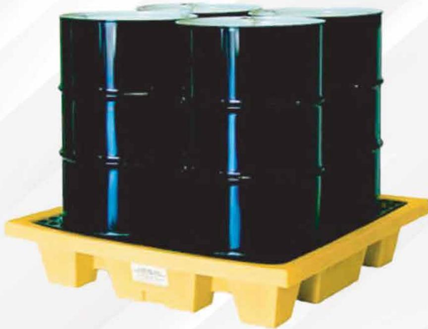
Cuenta con capacidad de derrame de hasta 250 Litros. Diseñada para soportar 4 tambos industriales de 200 litros, incluye 2 Rejillas HDPE removibles, facilitan su uso y limpieza.
